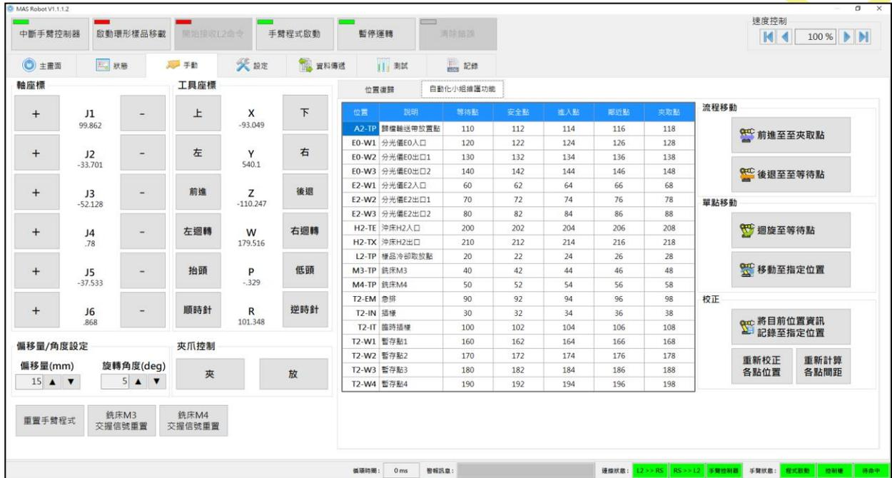
本系统移栽手臂专用监控接口(SCADA)，除了提供操作人员对于目前环内移栽状态、排程的监视外。亦提供完整的手臂移动、复归、教点等功能，用户可以轻松的进行个手臂位置的维护与调整，降低用户学习曲线、提升维护效率。
