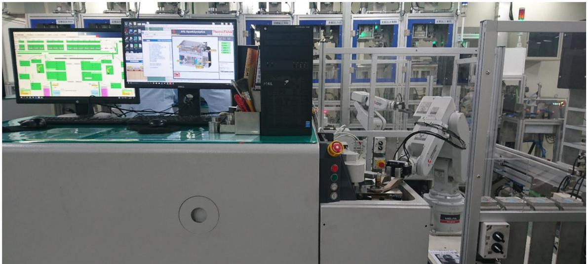
整合化验室既有 THERMO 分光仪与 HORIBA 氮氧分析仪，系统程序将待分析样品移入后，控制分析装置自动进行分析，并于分析后将结果回传 LAB。
